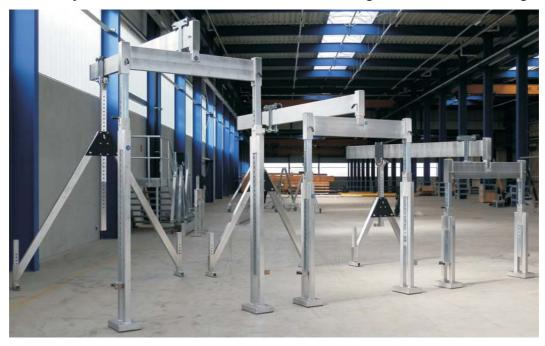
Es wird eingesetzt, wenn ein klappbares Seitengestell nicht direkt hinter die zu hebende Last gestellt werden kann Das Portal hat zwei senkrechte Stützen und kann somit über der Last platziert werden
